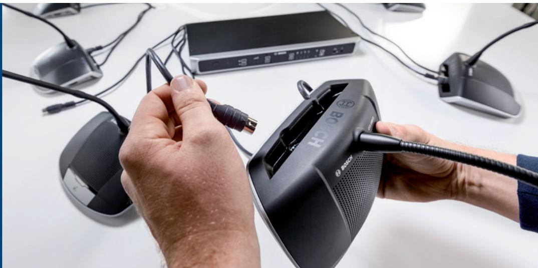
Le système est très rapide et facile à installer. Aucune formation ni aucun équipement supplémentaire ne sont nécessaires : les postes de discussion sont directement reliés à l'unité de contrôle via une simple connexion de câble en bus.
